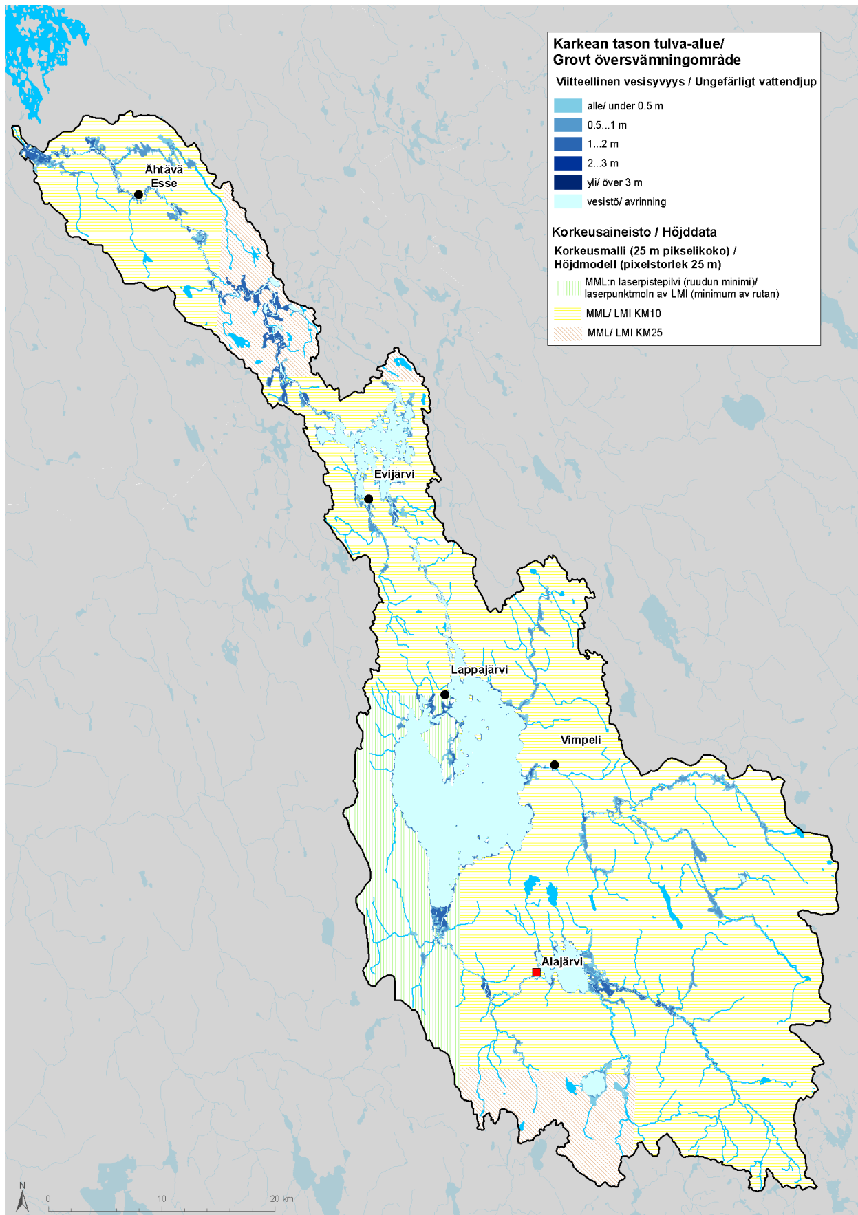
Kuva 15. Karkean mallin avulla määritetyt kerran tuhannessa vuodessa toistuvat tulva-alueet (ts. alavat alueet) Ähtävänjoen vesistöalueella. (© SYKE; ELY-keskukset; © Maanmittauslaitos lupa nro 7/MML/09)
